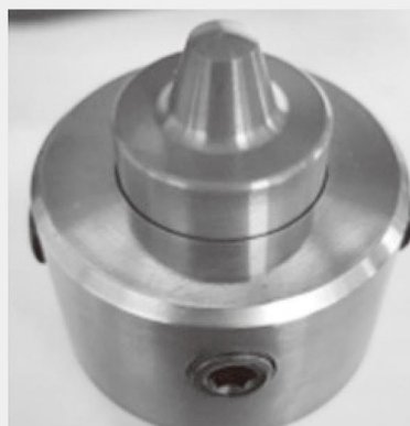
▲厚い鋼板用のNTKカッティングツールズ製FSW工具を研究に使った
